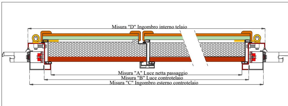
**Sezione telaio e controtelaio**
