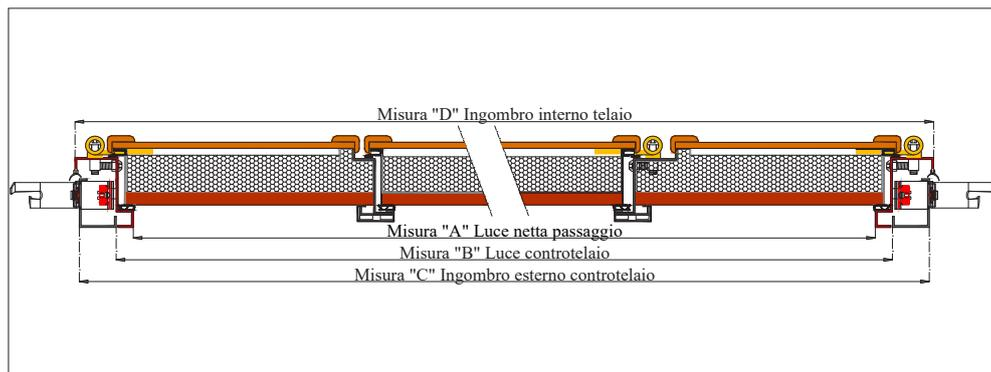
Sezione telaio e controtelaio
