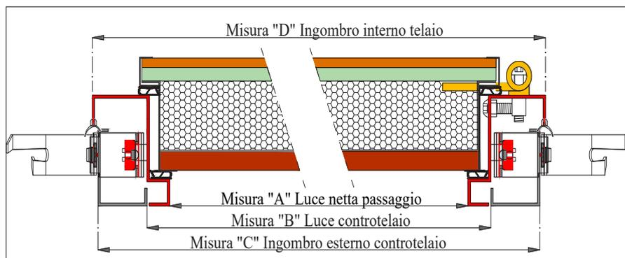
Sezione telaio e controtelaio
