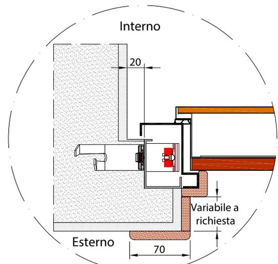
Montaggio con telaio in luce con cornici in legno
