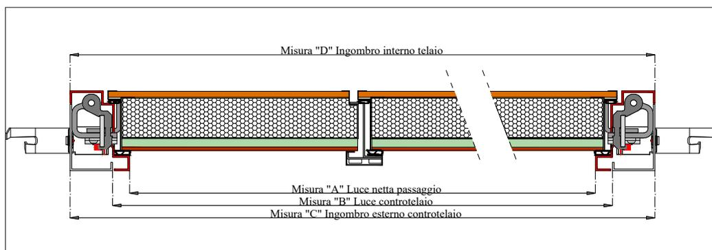
Sezione telaio e controtelaio
