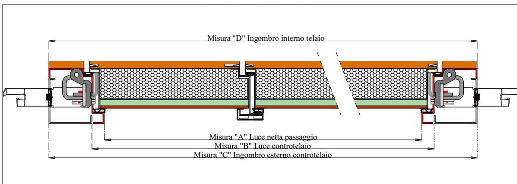
Sezione telaio e controtelaio
