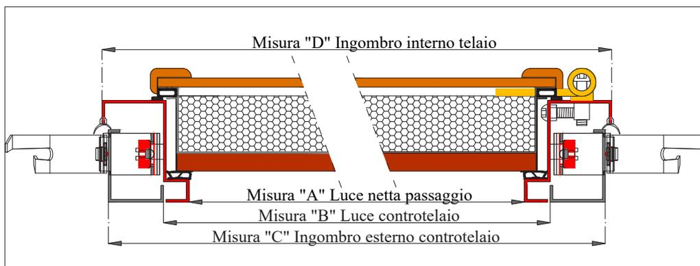
Sezione telaio e controtelaio
