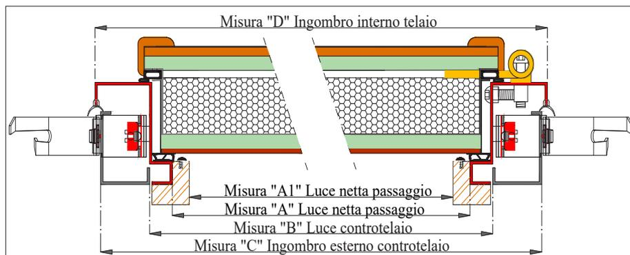
Sezione telaio e controtelaio
