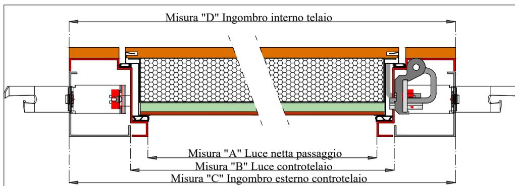
**Sezione telaio e controtelaio**
