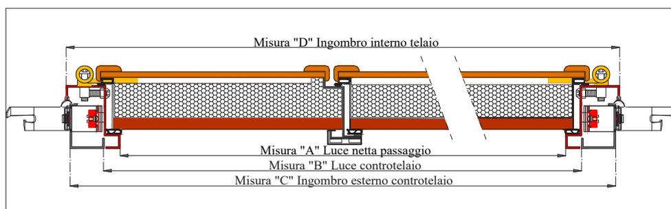
Sezione telaio e controtelaio
