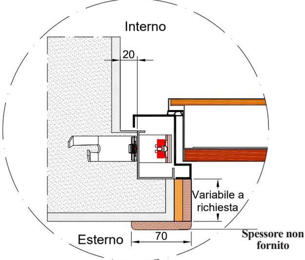
Montaggio telaio in luce con cornici, imbotti e coprifili in legno
