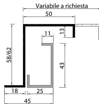
Telaio e contro telaio per applicazioni su telai in legno non removibili
