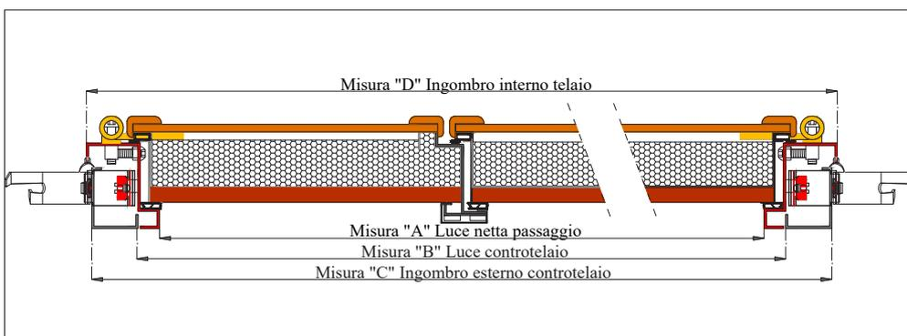
**Sezione telaio e controtelaio**
