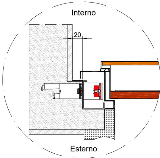
Montaggio con telaio in luce finitura in marmo
