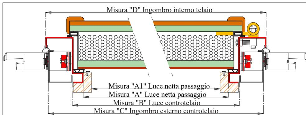
Sezione telaio e controtelaio
