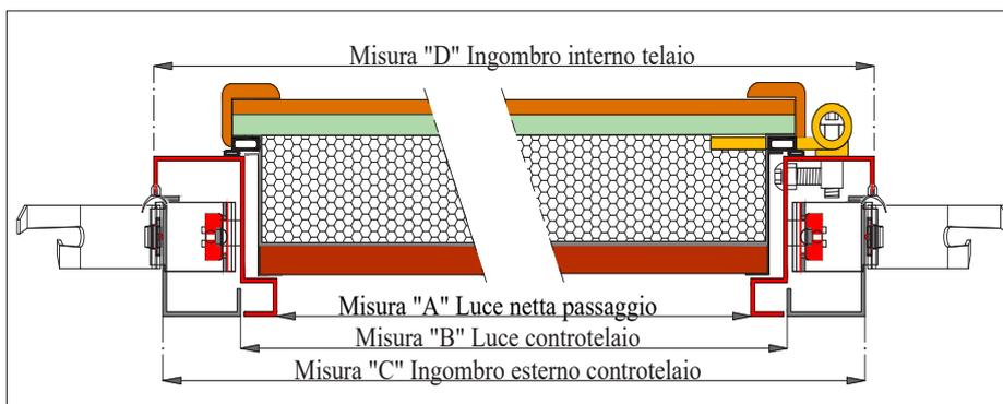
Sezione telaio e controtelaio
