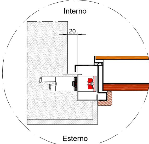
Montaggio con controtelaio in luce con coprifili in legno
