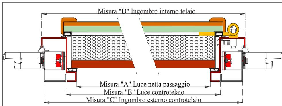
**Sezione telaio e controtelaio**
