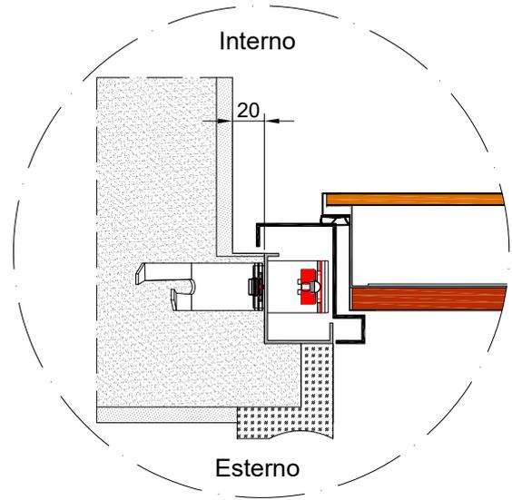
Montaggio con telaio in luce con imbotti e coprifili in legno
