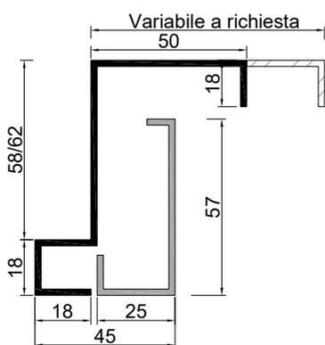
Controtelaio esterno ridotto e telaio con aletta su misura a richiesta
