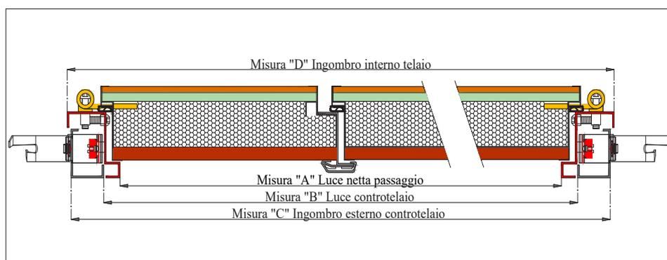
Sezione telaio e controtelaio
